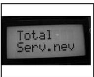
Индикатор типа счетчика моточасов. Общий - верхняя строка, межсервисный (если установлен) - нижняя строка.
