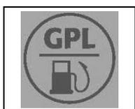
Индикатор переключателя вида топлива (для версий с газ-бензиновым двигателем)
