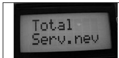
8. Второй экран показывает настройки по типу АКБ установленные на машине. с жидким В данном примере - свинцовые АКБ с жидким элеткролитом.
