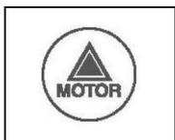
Индикатор амперометрической нагрузки щеточного мотора.
